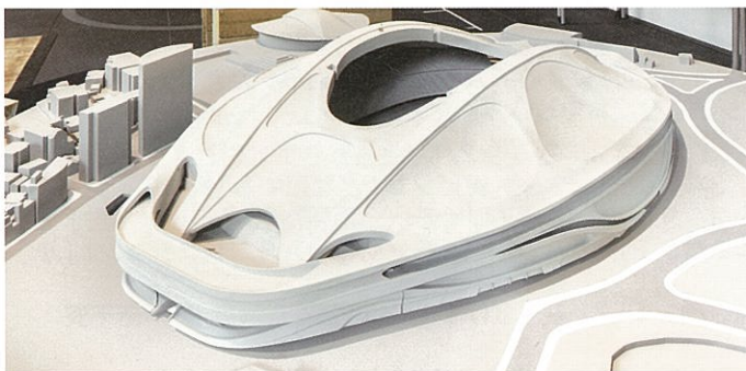
《新国立競技場案》2013年 ザハ・ハジド・アーキテクト+設計JV（日建設計・梓設計・日本設計・オーヴ・アラップ・アンド・パートナーズ・ジャパン設計共同体） 風洞実験模型（高さ75メートルの時点での模型、縮尺1/300） 写真提供：日建設計 写真撮影：小野強志
